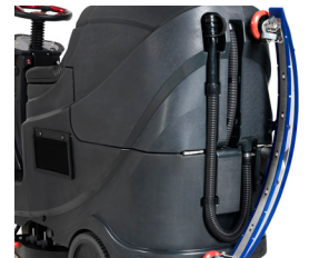
Soporte en la parte trasera para colgar la boquilla y poder pasar por zonas estrechas
