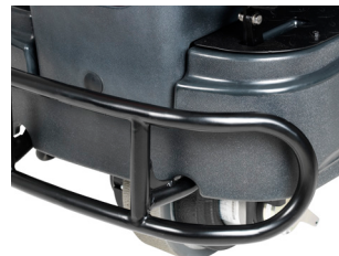
El parachoques delantero estándar protege la máquina para una vida útil más larga
