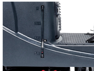
Indicador de nivel de solución de agua con volumen visible en el depósito
